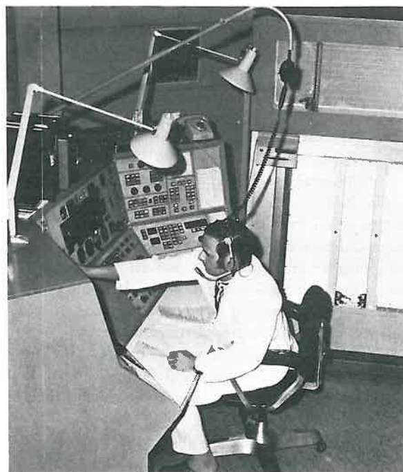
Instruktörsstationen till J35F-simulatören på F13. Bengt Stållborn gör dagens inställning före "flygning".
